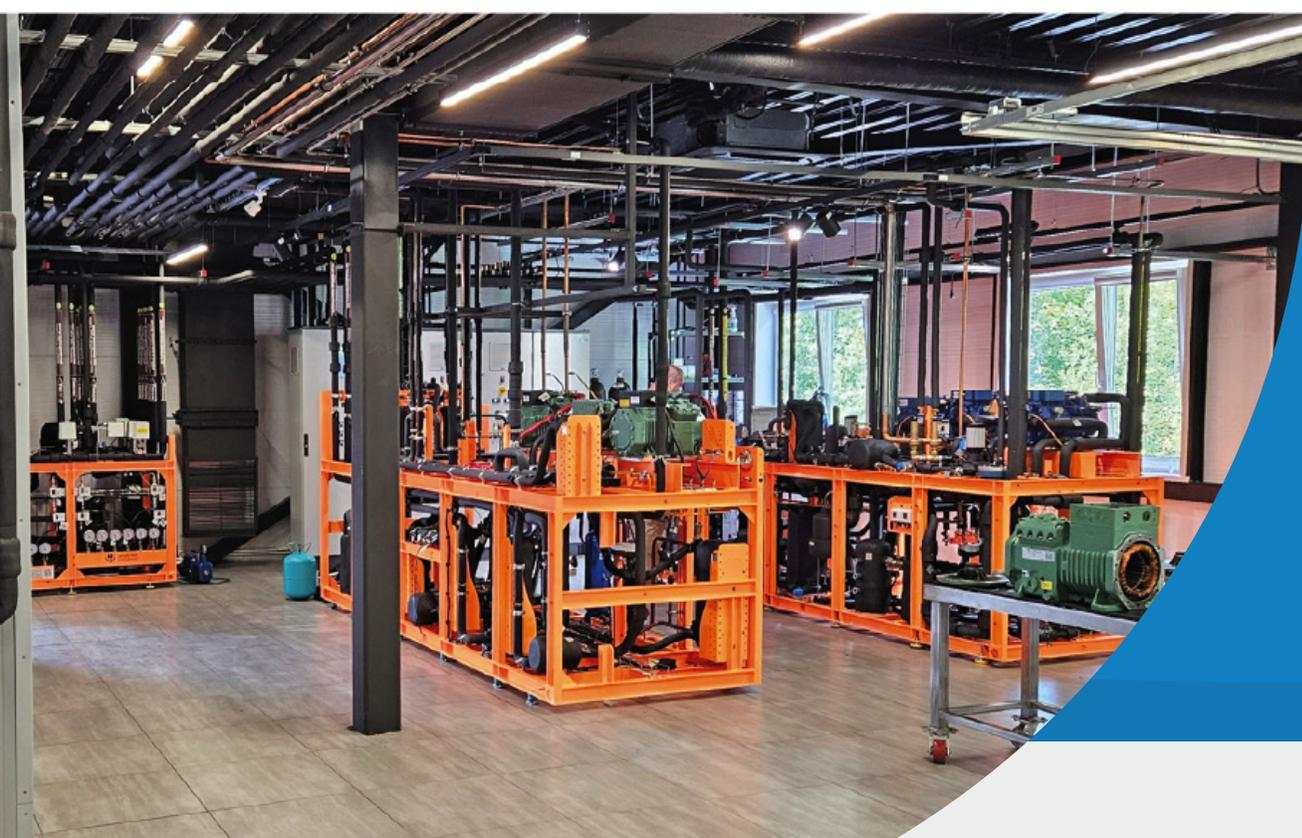
**-40** Проверка применяемых компонентов в низкотемпературных камерах при  $-40\text{ }^{\circ}\text{C}$ .
